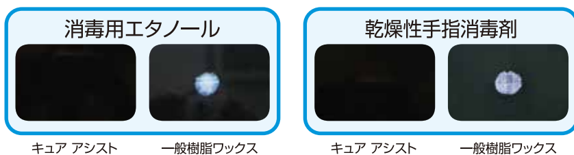
（試験条件）各樹脂ワックスを3層塗布し、室温で1日放置。その上に各消毒剤を滴下・風乾させ、皮膜を観察。
